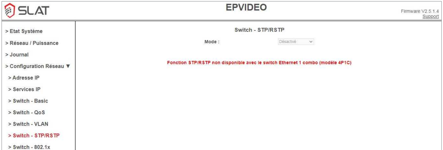
Figure 9-10 - Page Configuration Réseau - STP/RSTP
