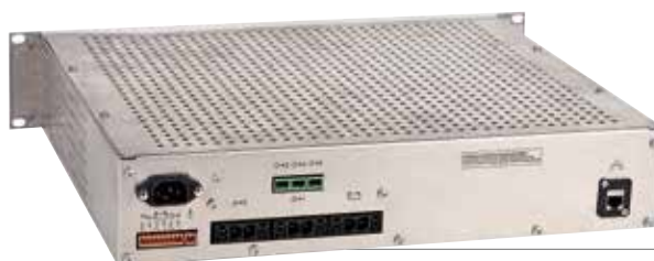
Rack 2HE - Vorderseite 483 x 89 x 395 mm
